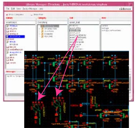
Abbildung 1.11: Prototypbibliothek von Assertions implementiert in Verilog-A und Verwendung in einem OP
